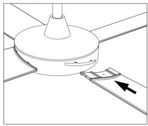
Insert the fan blades into the fan body.
